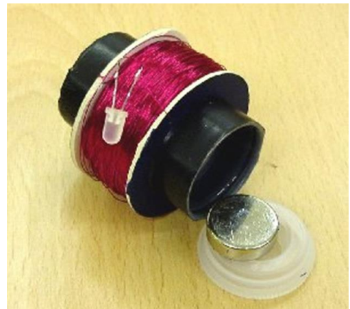
FIGURA 21 IL DISPOSITIVO REALIZZATO DAGLI STUDENTI DEL LICEO A. GATTO PER RICAVARE ENERGIA ELETTRICA DALLE ONDE DEL MARE
