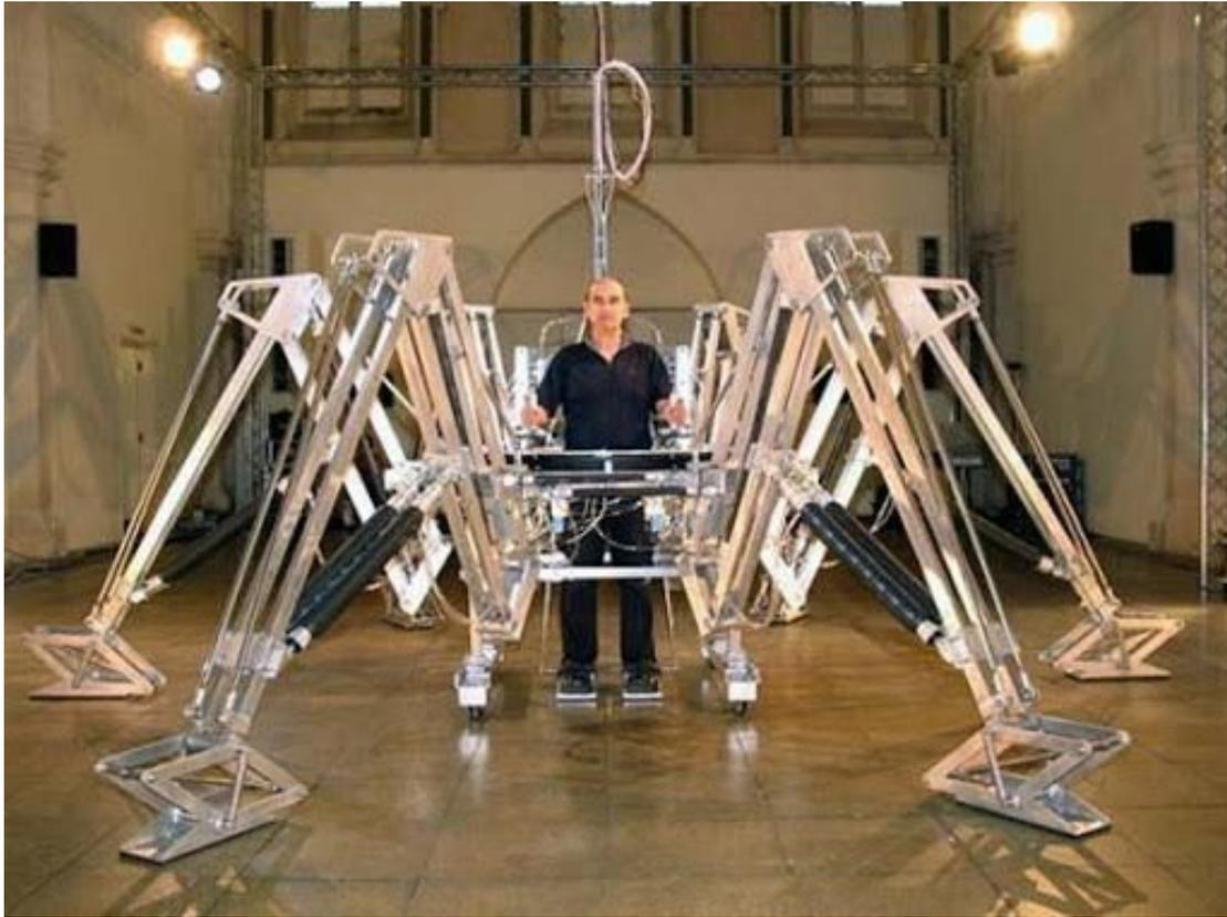
Figure 78 Stelarc – Muscle Machine, un sistema ibrido uomo-macchina, alimentato pneumaticamente mediante attuatori muscolari, Londra 2003.
